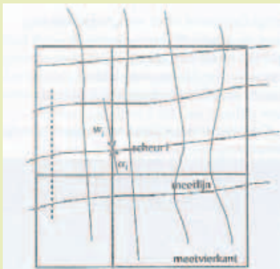
Figuur 2 Principe van het meten van de relatieve cumulatieve scheurwijde \epsilon_{ASR}
