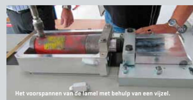
Versterken van een vloer met koolstof lamellen.
